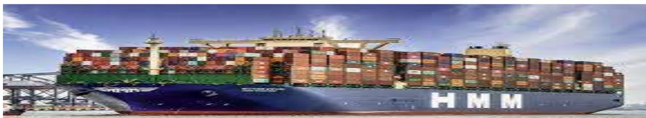
São os navios semelhantes aos de carga geral mas normalmente não possuem além de um ou dois mastros simples sem paus de carga. As escotilhas de carga abrangem praticamente toda a área do convés e são providas de guias para encaixar os contêineres nos porões. Alguns desses navios têm guindastes especiais.
