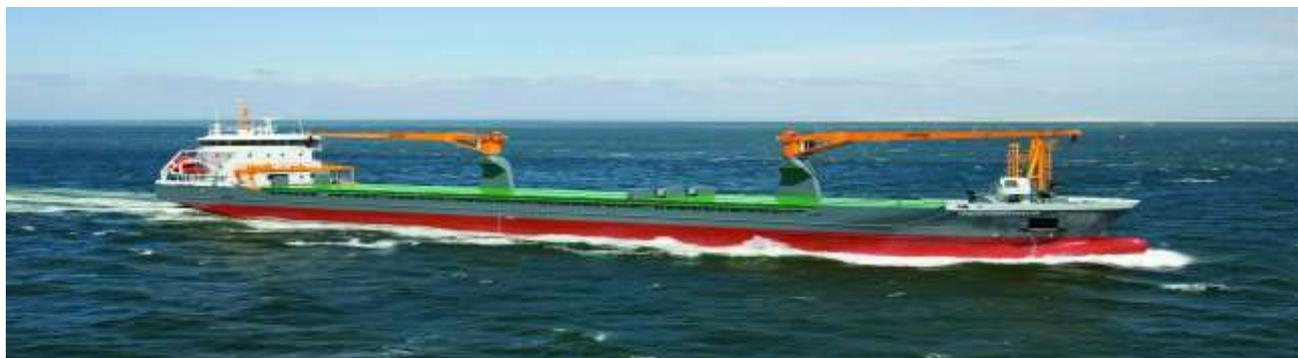
São os navios que transportam vários tipos de cargas - sacarias, caixas, veículos encaixotados ou sobre rodas, bobinas de papel de imprensa, vergalhões, barris, barricas etc. Tem aberturas retangulares no convés principal e aberturas chamadas escotilhas, por onde a carga é embarcada para ser arrumada as cobertas e porões. A carga é içada ou arriada pelo equipamento do navio ( chamados paus de carga) ou pelos guindastes do porto.
